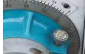
Delme Derinlik Ayar Mekanizması
