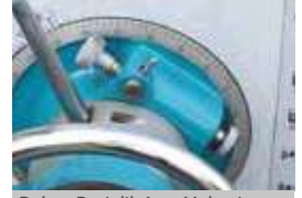
Delme Derinlik Ayar Mekanizması
