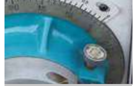
Delme Derinlik Ayar Mekanizması
